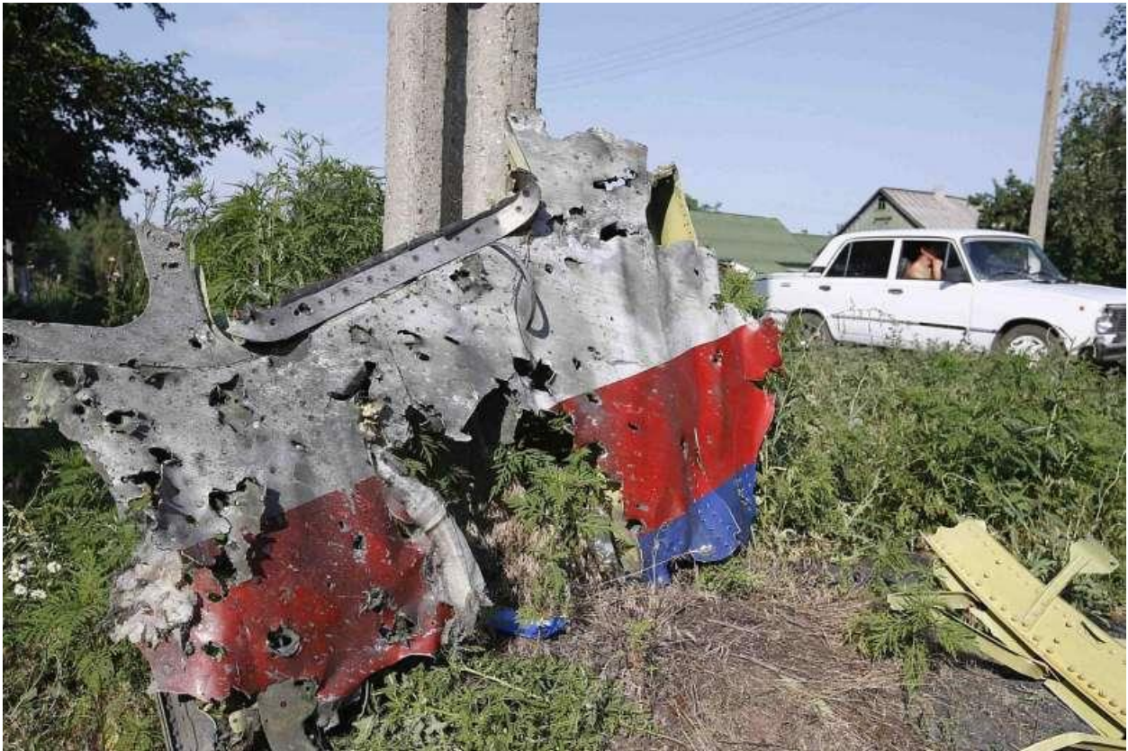
Фото №16. Обломок №7. Левая часть кабины пилотов.
