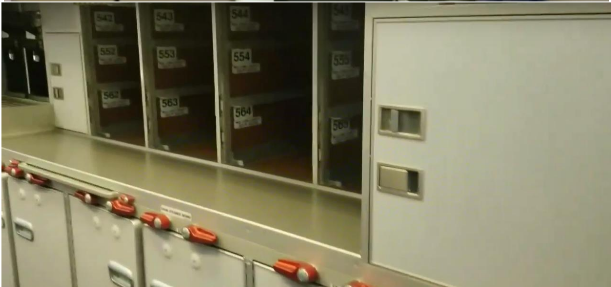
Фото №8. Целый ряд коротких рукояток красного цвета на технологическом оборудовании центральной кухни. Бортовая центральная кухня находится в центральной части между двумя проходами вдоль кресел салона. На совмещённом фото видны в проходе кресла бизнес-класса.
