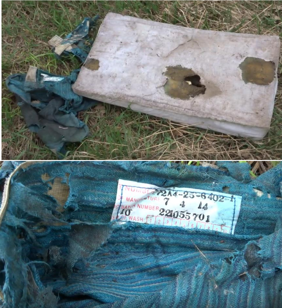
Фото №11. Обломки №1. Мягкий ложемент пассажирского кресла и обивка кресла салона эконом-класса
