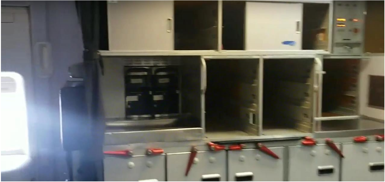
Фото №6. Чередующиеся короткие и длинные красные рукоятки технологического оборудование задней бортовой кухни.
