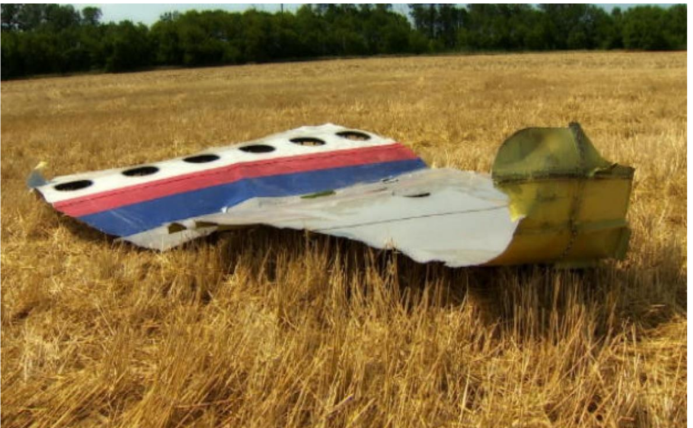
Фото №13. Обломок №4. Боковая левая обшивка фюзеляжа в районе клапанов избыточного давления.
