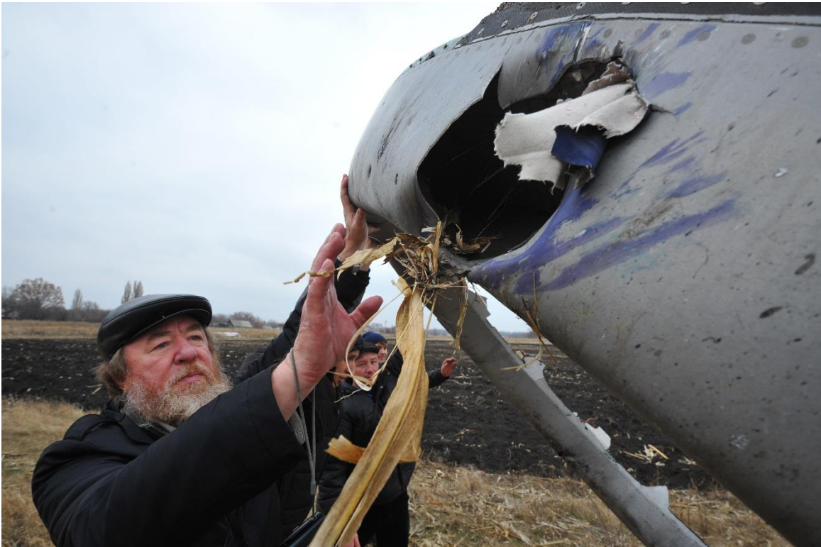
Фото №19. Николай Варсегов и обнаруженный им в поле диффузор левого двигателя.
