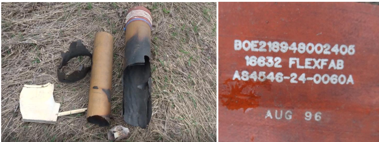
Фото №12. Обломок №2. Обгорелые фрагменты транзитных воздуховодов.
