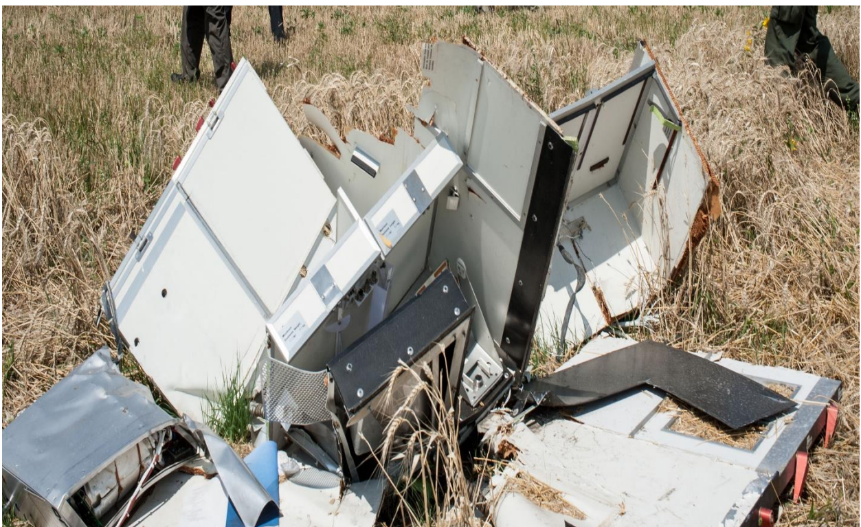
Фото №17. Обломок №8. Технологическое оборудование центральной кухни.
