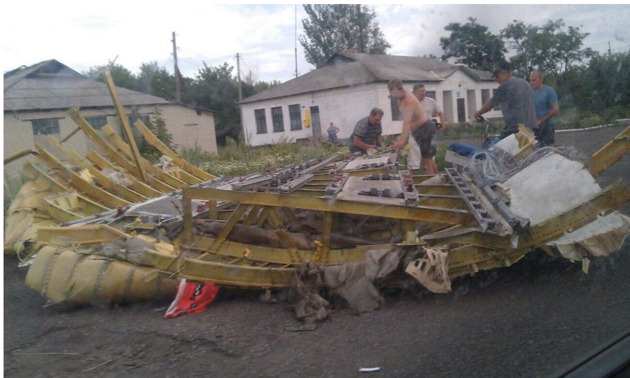
Фото №15. Обломок №6. Фрагмент нижней части фюзеляжа с полом первого грузового отсека. На фрагменте на переднем плане загрузочная площадка, находящаяся напротив двери грузового отсека. Вид со стороны носовой части самолёта.
